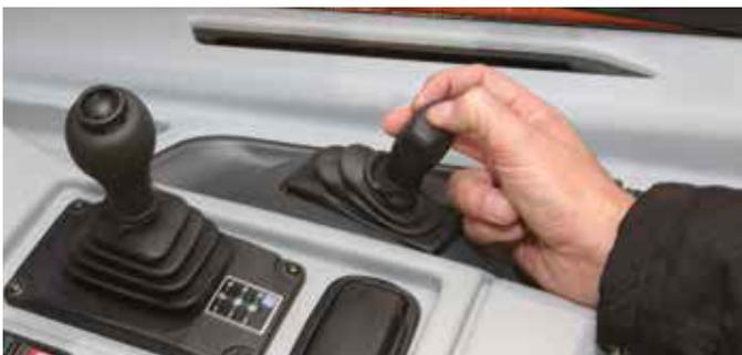
**Palanca de elevación del volquete**
