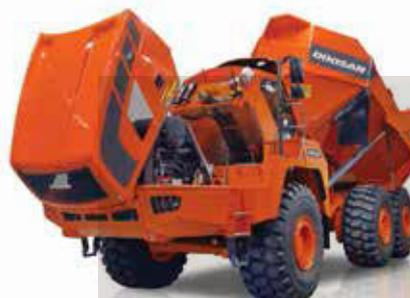
**Acceso para mantenimiento:** se ha mejorado el acceso al motor y la transmisión; además, la cabina se inclina hacia atrás para facilitar el servicio y mantenimiento de los principales componentes.
