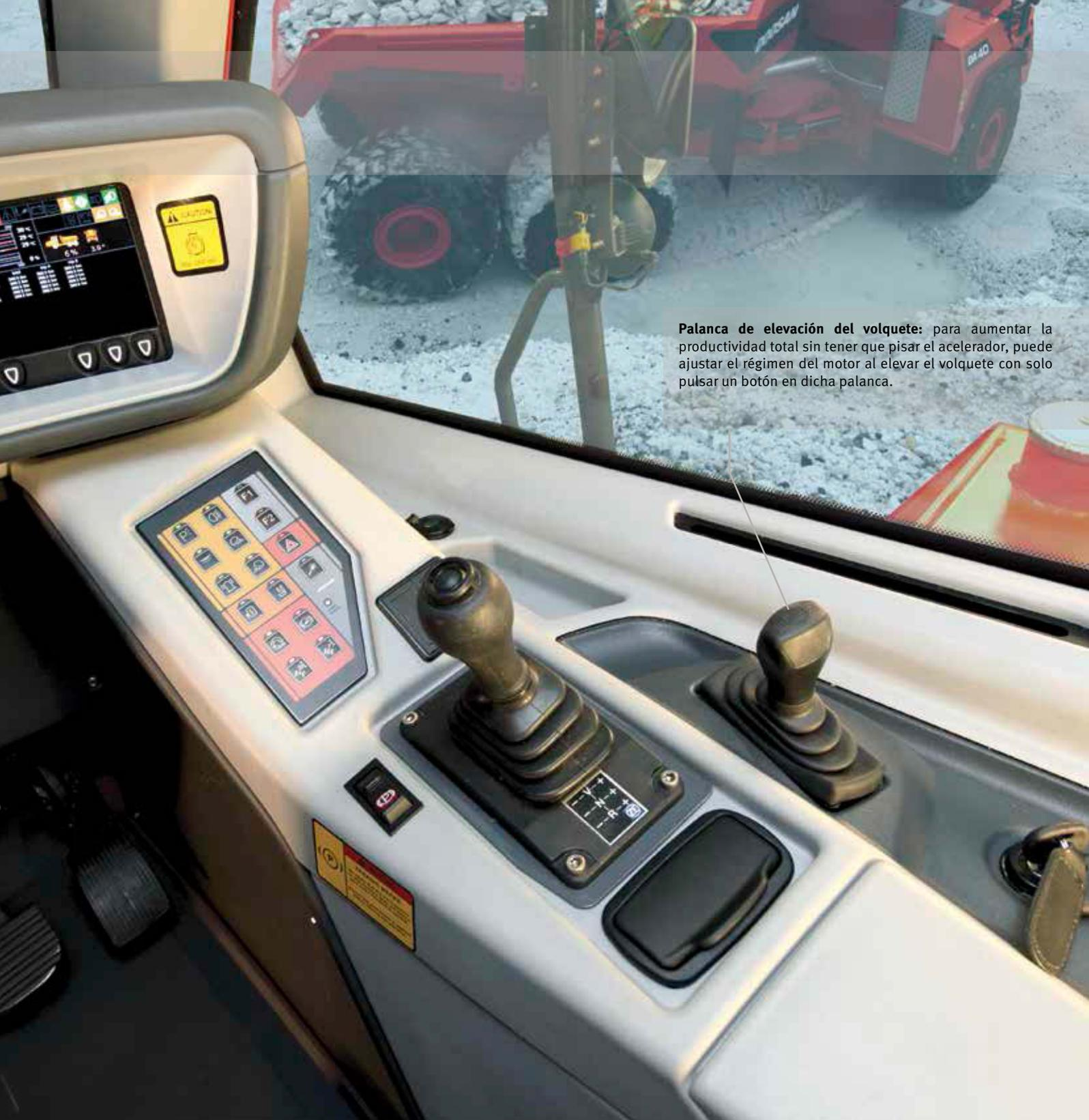
**Palanca de elevación del volquete:** para aumentar la productividad total sin tener que pisar el acelerador, puede ajustar el régimen del motor al elevar el volquete con solo pulsar un botón en dicha palanca.
